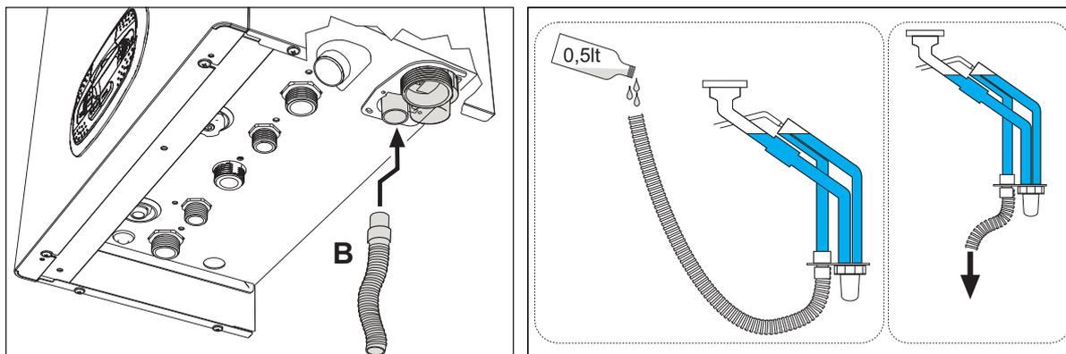
рис. 28- Подсоединение трубы для слива конденсата
