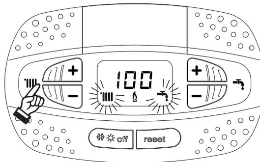
рис. 31- Режим TEST (мощность системы отопления = 100%)
