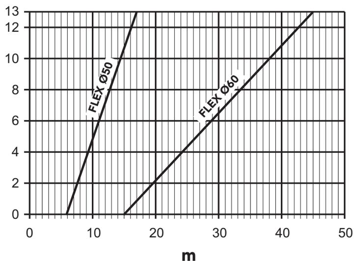
рис. 26- График выбора параметров дымохода
