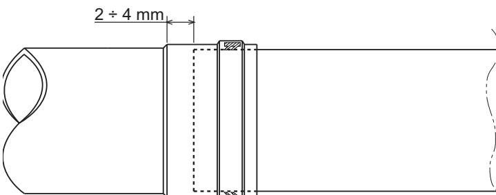
рис. 8 - Тепловое расширение
