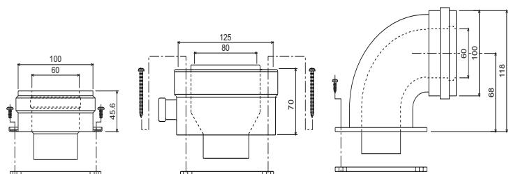
рис. 10 - Начальные элементы для коаксиальных воздуховодов
