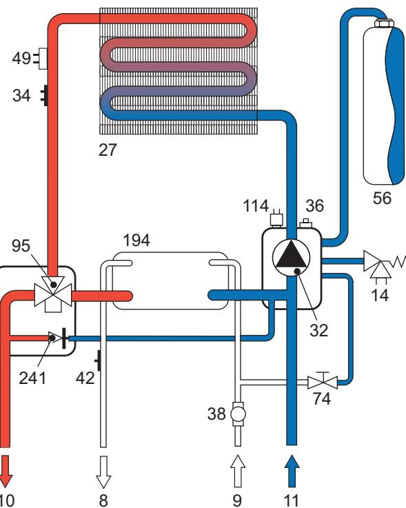
рис. 18 - Отопительный контур
