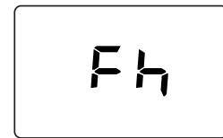
рис. 7- Выпуск воздуха с выключенным вентилятором
